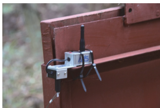
(図2) センサノードを里山の熊のオりに設置
